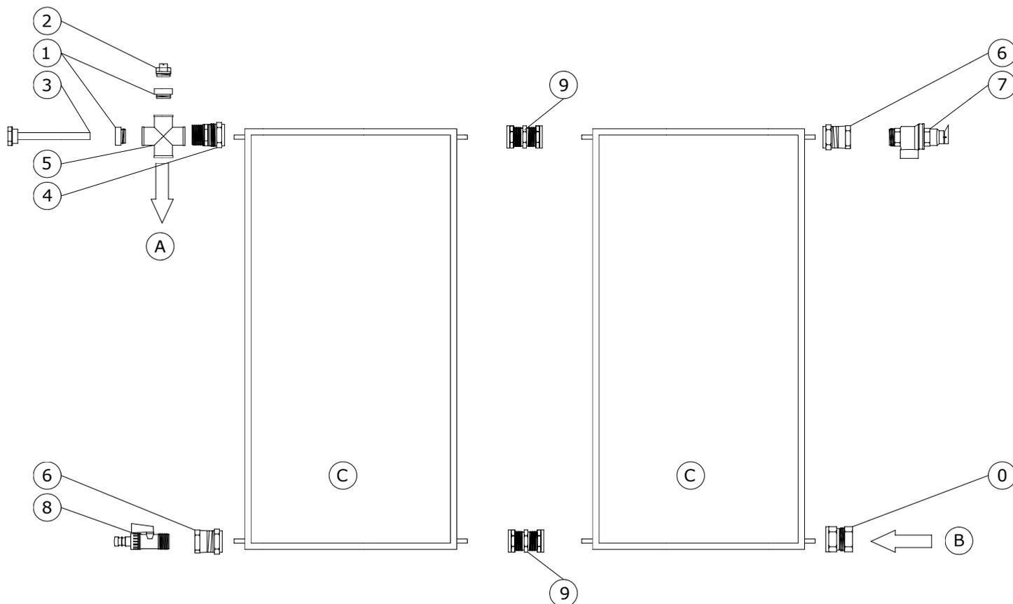
Per ogni ulteriore collettore aggiuntivo è necessario aggiungere un kit RAC+I, composto dai due raccordi dritti doppi (indicazione 9). Si consiglia di collegare alla mandata A e al ritorno B due tubi di rame da 22 con bloccaggio a stringere.
